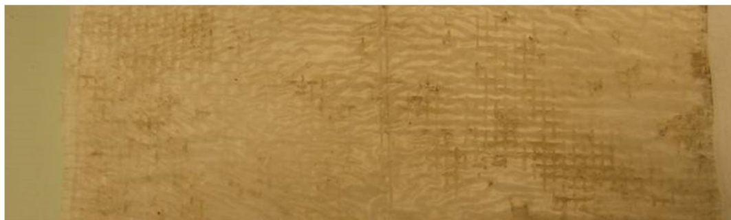
7. ábra: Tisztítási folyamat után a műanyag felületén maradt szennyeződés (238-as minta; változó vegyértékű fém sókkal adalékolt PE fólia).
