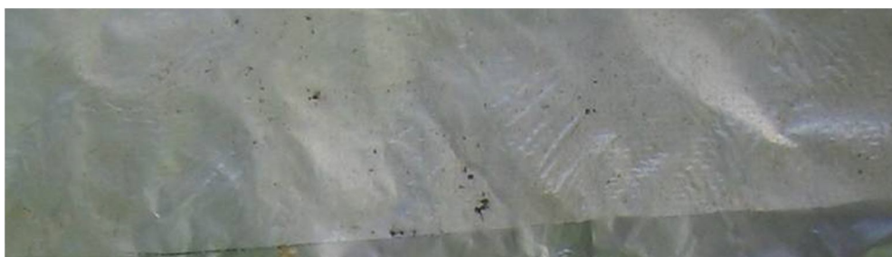
6. ábra: QualBio fóliaminta komposztálás után (változó vegyértékű fémsókkal adalékolt polietilén, kereskedelmi forgalomban kapható).
