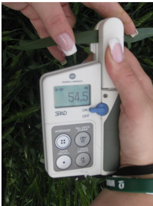
1. ábra Klorofill mérés a SPAD 502-es klorofill mérőműszerrel
