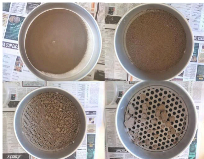
7. ábra: Az első kísérleti tábla agronómiai szerkezetvizsgálatának eredményei a szitasoron (saját fotók)
