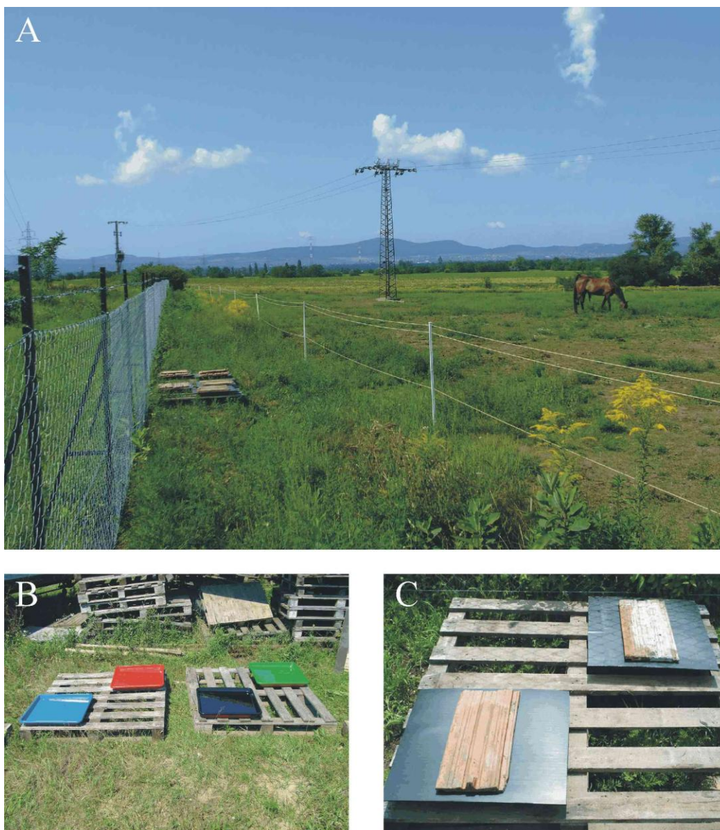
1. ábra: (A) A lovarda Gödön, ahol az első terepkísérlet történt. (B) Az étolajjal töltött kék, vörös, fekete és zöld tálcák elrendezése. (C) Esős időben és minden este/éjszaka a tálcák fekete műanyag lapokkal voltak lefedve és cserepekkel lesúlyozva.
