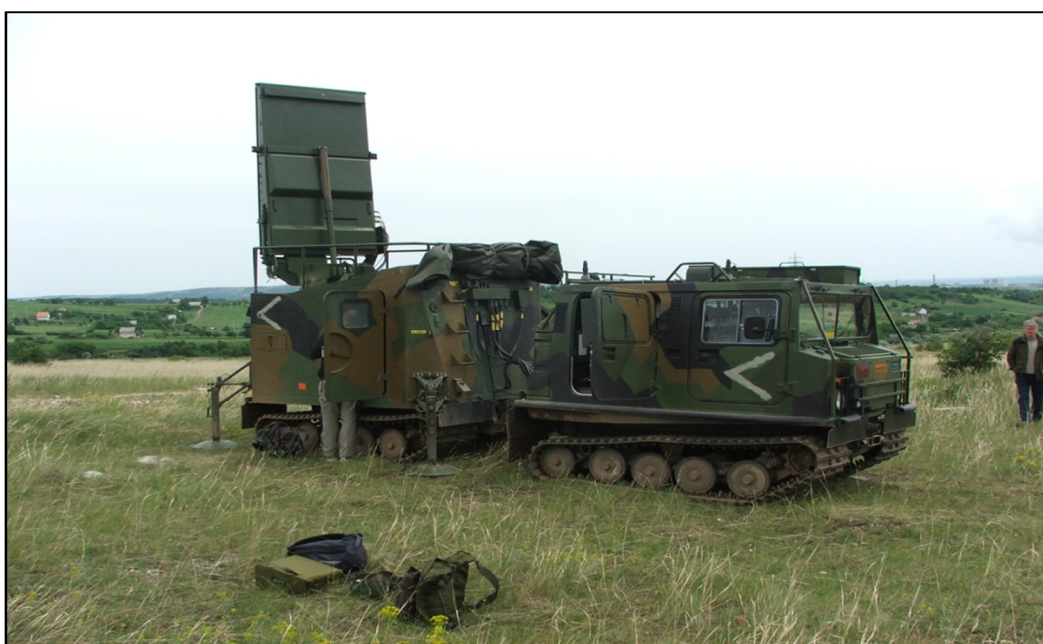
22. számú kép: Az ARTHUR tűzeszköz felderítő lokátor képes nagy pontossággal előremetszeni az ellenséges tűzeszközt az ellenség által kilőtt lövedék röppályája alapján 38
