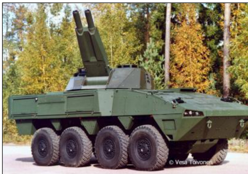
25. számú kép: Az AMOS rendszer, egy Patria AMV páncélozott szállító harcjárművön 42
