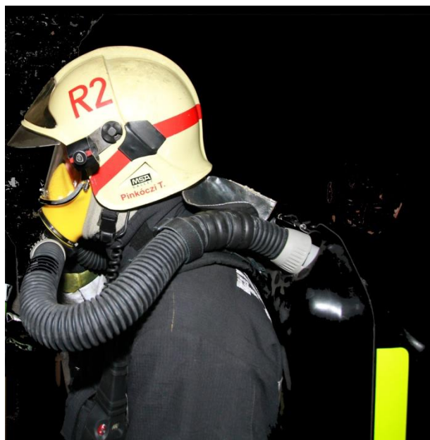
4. Kép Légző cső elhelyezkedése. Forrás: Jamrik András 2009
