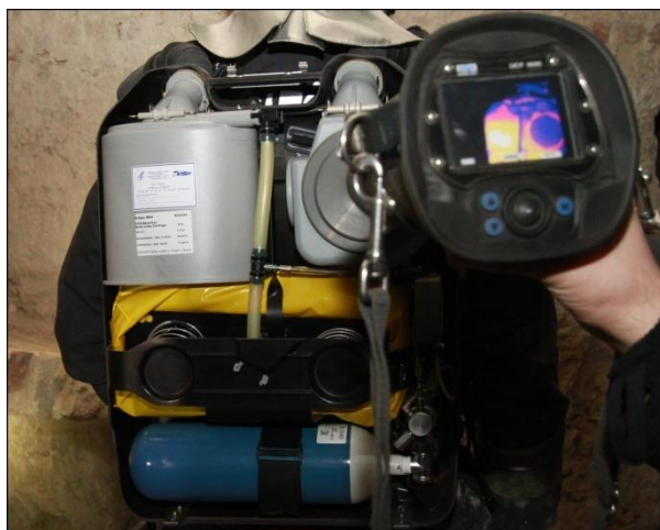
10. Kép: HŐKÉP. Külső hőmérséklet 13 Celsius, lúgos szelence hő képe a kamera kijelzőn. Forrás: saját 2009
