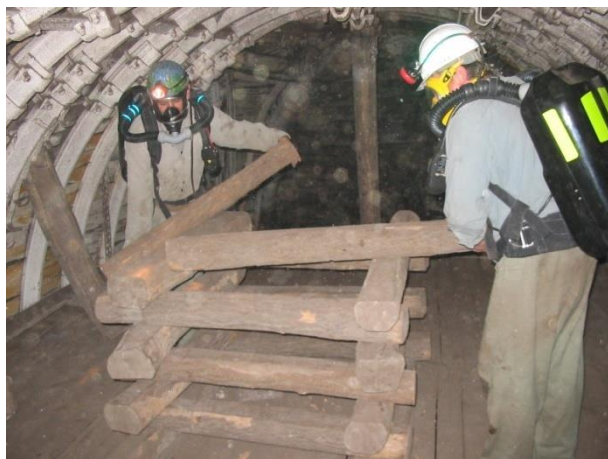
27.Kép: Bányamentő gyakorló pálya, alátámasztás építése. Forrás: Elekes Gábor 2007
