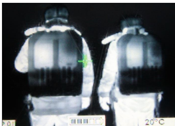
9. Kép: HŐKÉP. Külső hőmérséklet 13 Celsius, Légző készülékek üzemi hőfokon.
