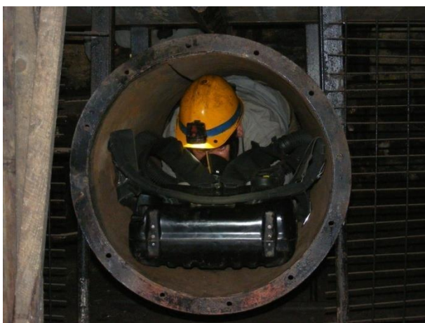
32. Kép: Bányamentő gyakorló pálya. Szűk keresztmetszetű átjárón átbújás légzőkészülék levételével. Forrás: Elekes Gábor 2007
