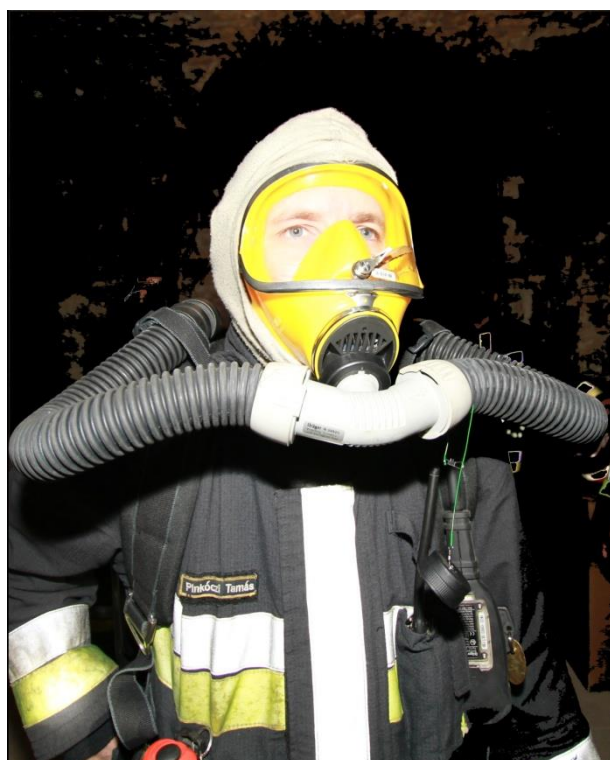
3. Kép Csatlakozó idom az állarcban, kámzsa eligazítva. Forrás: Jamrik András 2009
