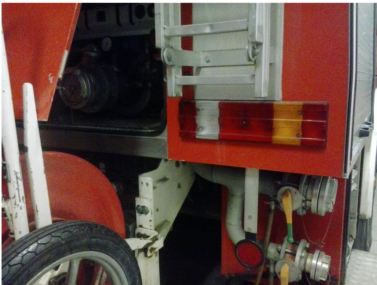
13. ábra Szívócsonk és nyomócsonkok a Mercedes-Benz ULF 4000/2000/1000 típusú járművön Forrás: saját felvétel
