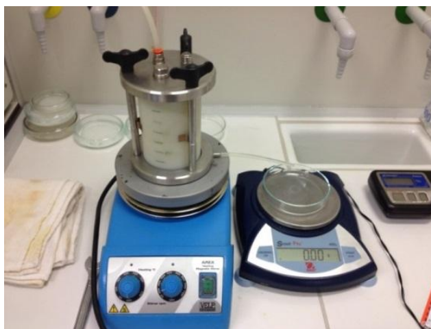
11. ábra: Membránszűrő berendezés működésre kész állapotban (fotó: Vitay Dóra)
