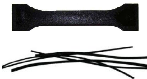
23. ábra A mechanikai vizsgálatokhoz alkalmazott extrudált szálak és fröccsöntött próbatest
