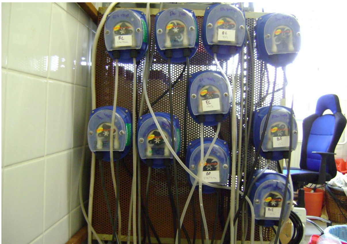
M2. ábra. A szennyvíz feladását és a tisztított szennyvíz elvételét biztosító perisztaltikus pumpák
