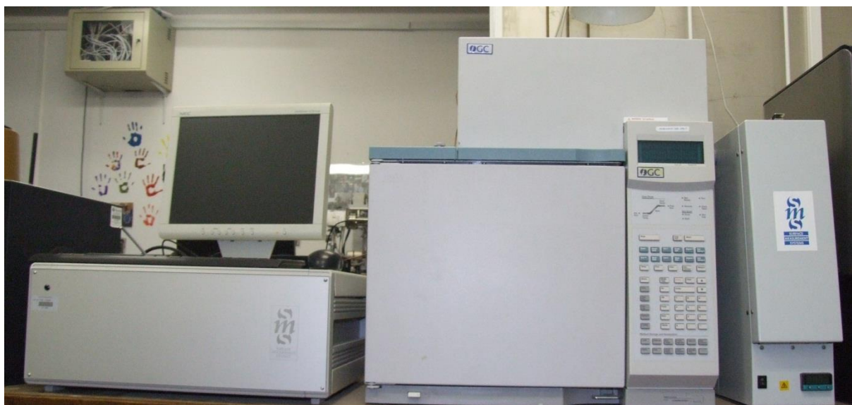
2. ábra Agilent 6890 GC felületi mérő rendszerrel (SMS).
