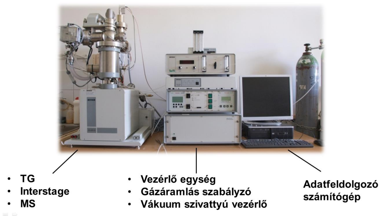
10. ábra: NETZSCH STA 409 CD + QMS 403/5 tömeg-spektrométer, SKIMMER kapcsolódással
