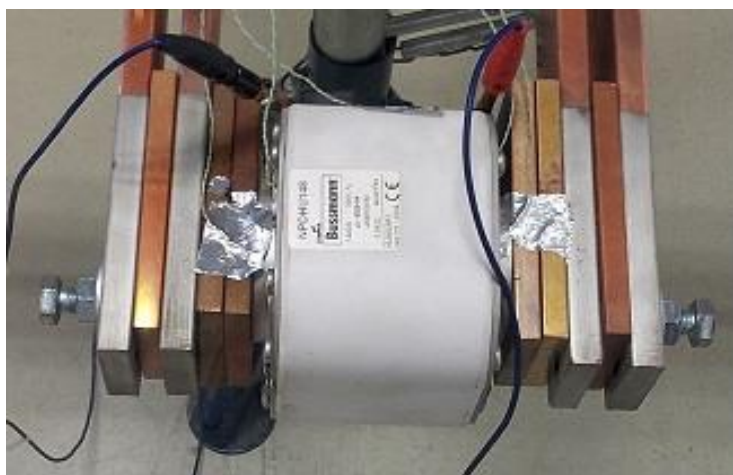
49. ábra Az ábrán látható a mérőkábelek elhelyezése a biztosítón
