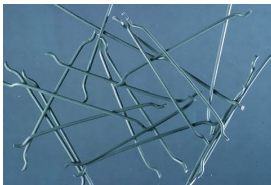
(acélhaj betonerősítő elemek)
