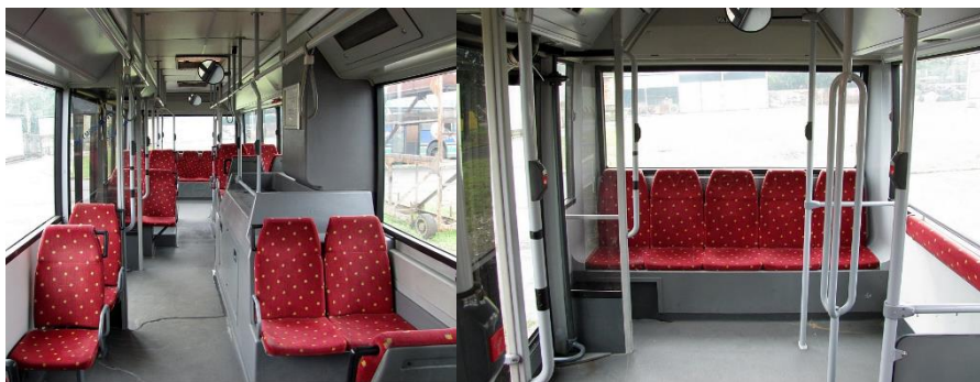
44. ábra: Van Hool A300 típusú autóbusz utastere. Jól megfigyelhető a nagyméretű motorsátor a második ajtóval szemben, illetve az igen tágas hátsó traktus. 4
