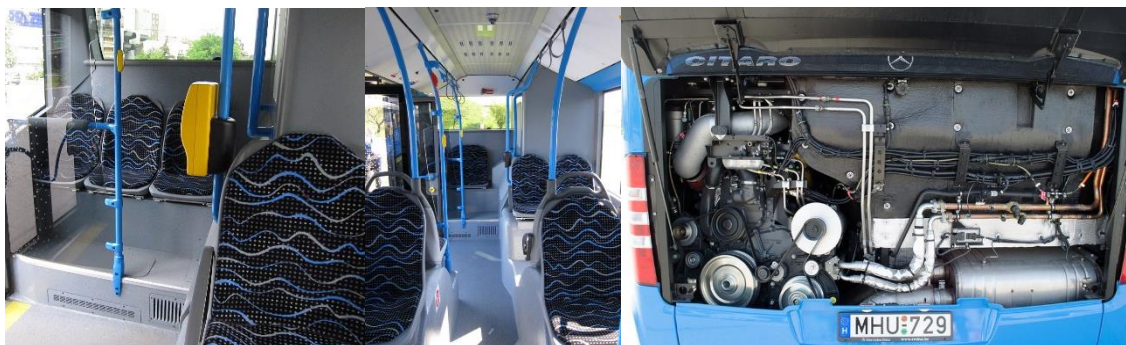
45. ábra: Álló elrendezésű, EEV motor beépítése, motorsátor alkalmazásával. 5
