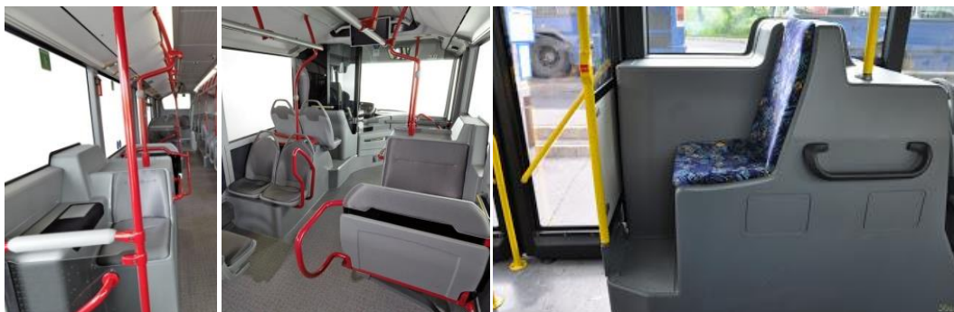
1. ábra: Példák kerékdobok beépítésére (Mercedes-Benz Citaro, Volvo 7700 Hybrid). 2
