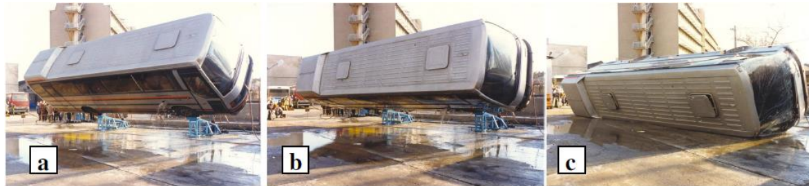
8. ábra: Standard baleseti elrendezésű borításos vizsgálat. Jól megfigyelhető a létrejövő deformáció. 10
