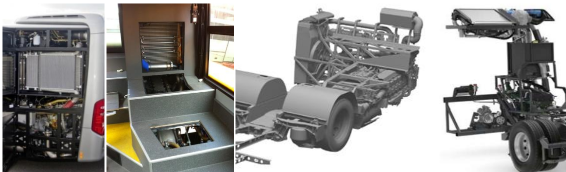
4. ábra: Jellemző hűtőrendszer elhelyezések (Mercedes-Benz, MAN, Credo, Volvo). 5
