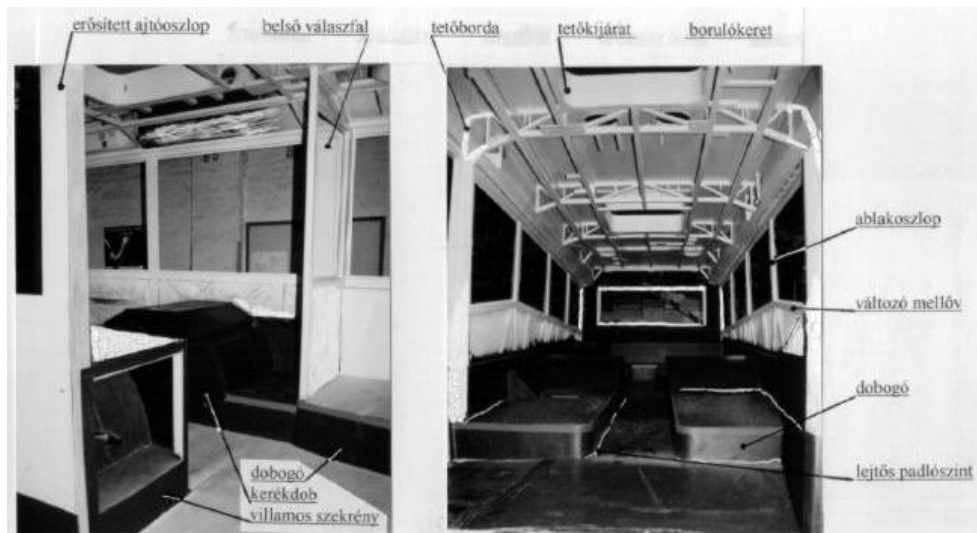
14. ábra: Merevítő szerepkörrel rendelkező szerkezeti elemek. 21
