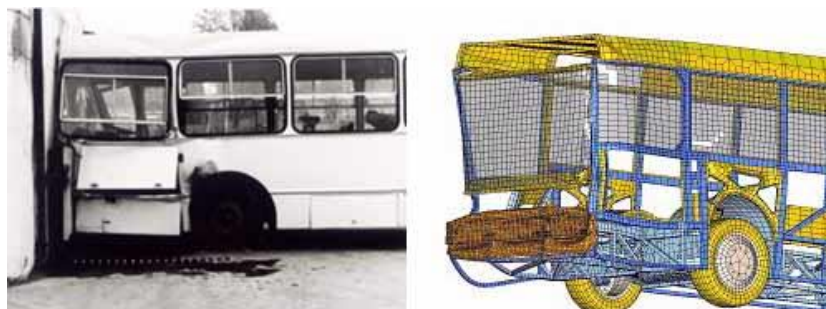
9. ábra: Az Ikarus 415 prototípusának kísérleti ütközéses vizsgálata és számítógépes szimulációja. 12
