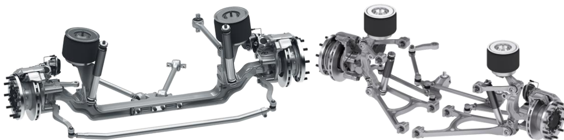
20. ábra: Balra a ZF RL 75 A merev, jobbra pedig a ZF RL 75 EC független kerékfelfüggesztés. 28
