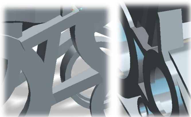
9. ábra Bal oldalon Z átkötés, jobb oldalon srégen kialakított bordák
