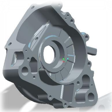
2. ábra az EVO 2 motor forgattyúházának CAD modellje
