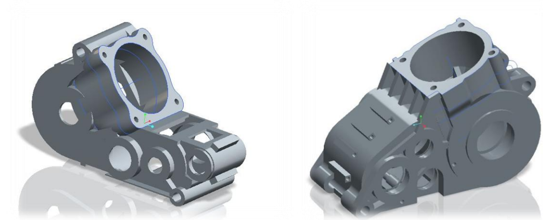
3. ábra Bal oldalon 60°-os, jobb oldalon 20°-os hengerdöntés
