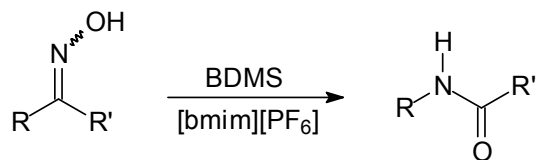
2. ábra. Bróm-dimetil-szulfónium-bromid katalizált Beckmann átrendeződés.
