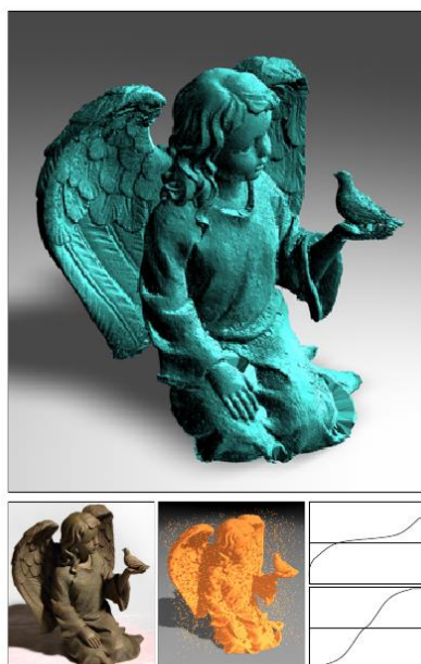
25. ábra Egy az eigencrust algoritmussal rekonstruált objektum. A 2 008 414 bemeneti pontból 12 926 063 tetraéder felhasználásával 3 605 096 kimeneti háromszög állt elő, 437 perc alatt. [23]
