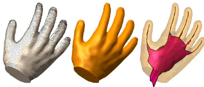
23. ábra Lézeres mérésből előállított pontfelhő, a belőle generált polygon modell és a hozzá tartozó középtengely transzformált. [22]
