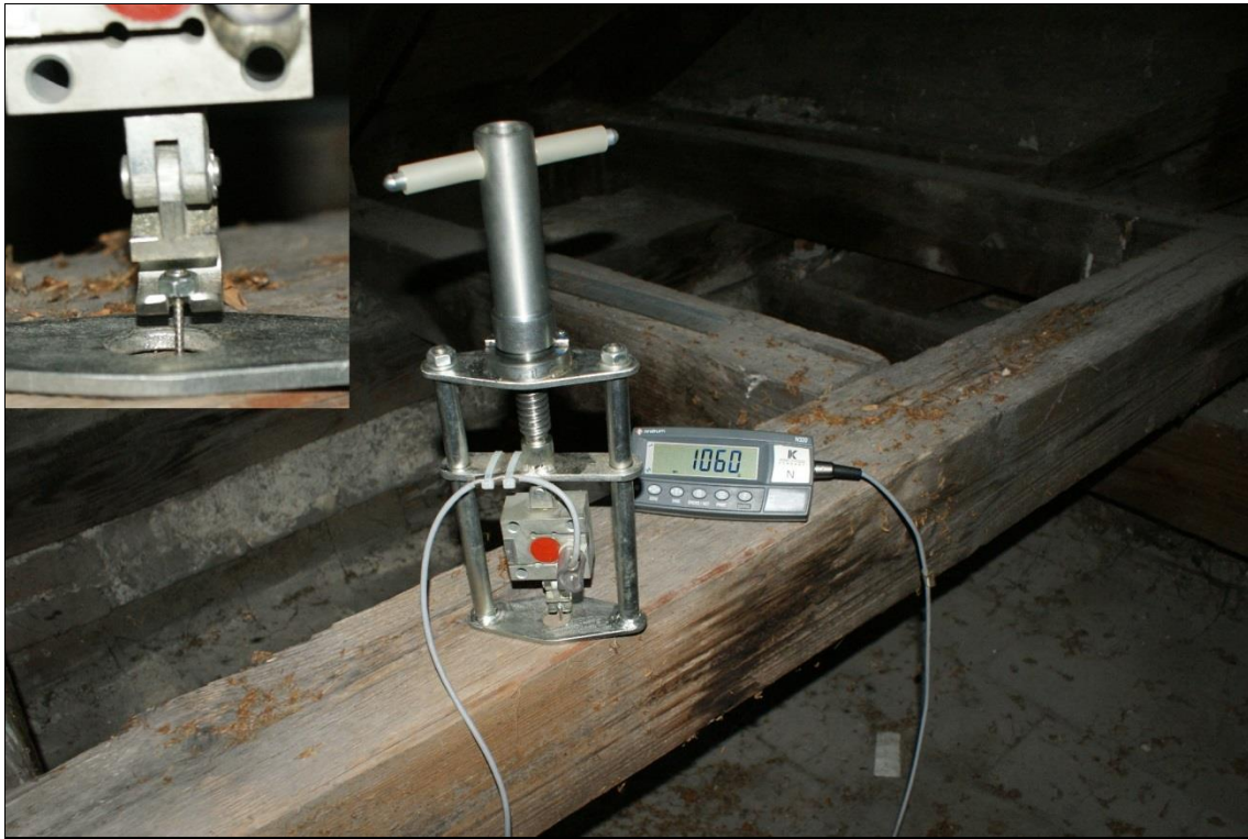
10. ábra: Csavarállóság mérése, a kijelzőn a mért legnagyobb érték, 1060 N-os kihúzással szembeni ellenállás és a megfogó fej (a szerző felvétele)
