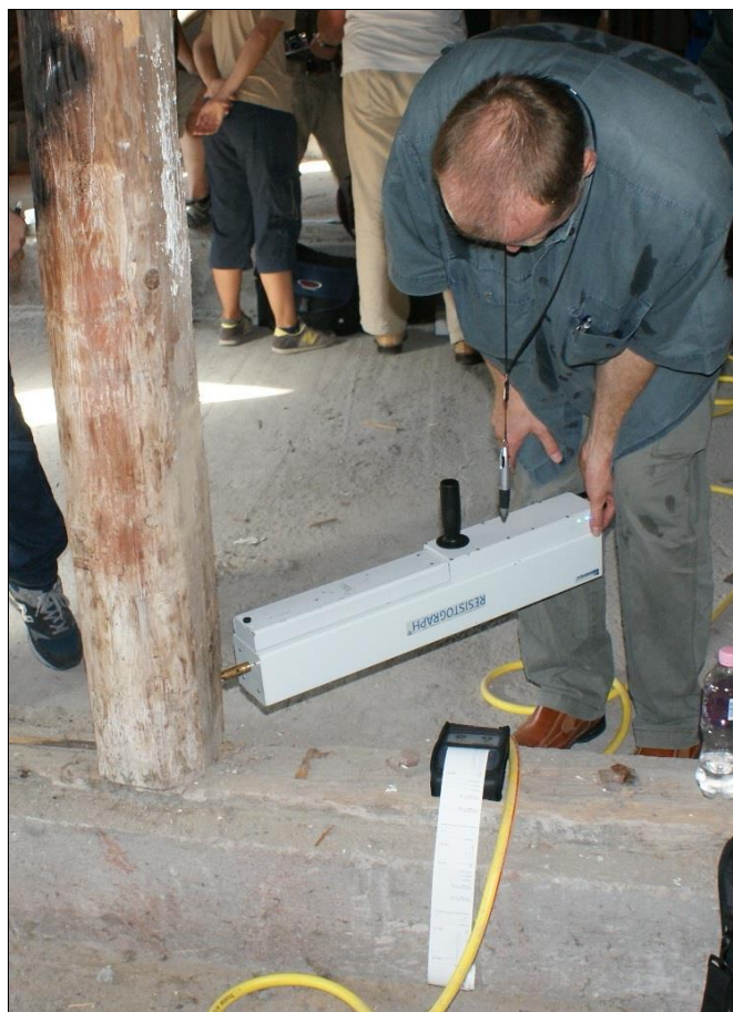
7. ábra: A Resistograph használata a soproni erdészeti múzeum székoszlopán (a szerző felvétele)
