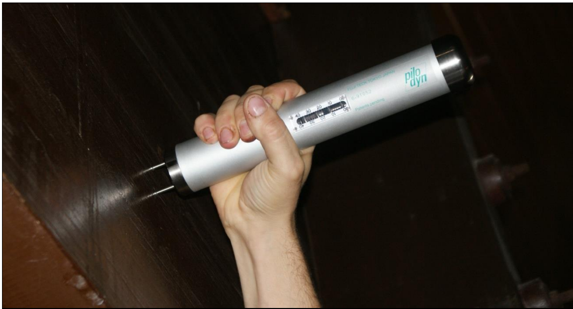
12. ábra: A Pylodin használat közben, felhúzott állapotban (a szerző felvétele)
