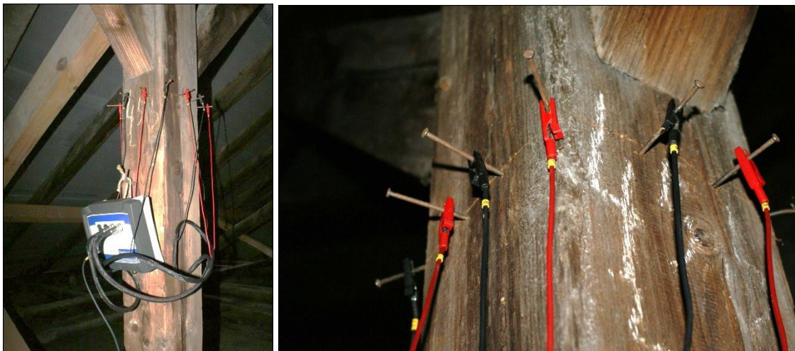
5. ábra: Az impedancia tomográf központi vevő egysége a rákötött elektródákkal (bal oldal), az egy síkban a gerendába beütött szegek és a rájuk csatlakoztatott elektródák (jobb oldal) (a szerző felvételei)
