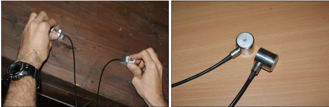
2. ábra: A 2 tappancsos típus használata RR tartó mérése közben és a henger alakú mérőszondák (a szerző felvételei)
