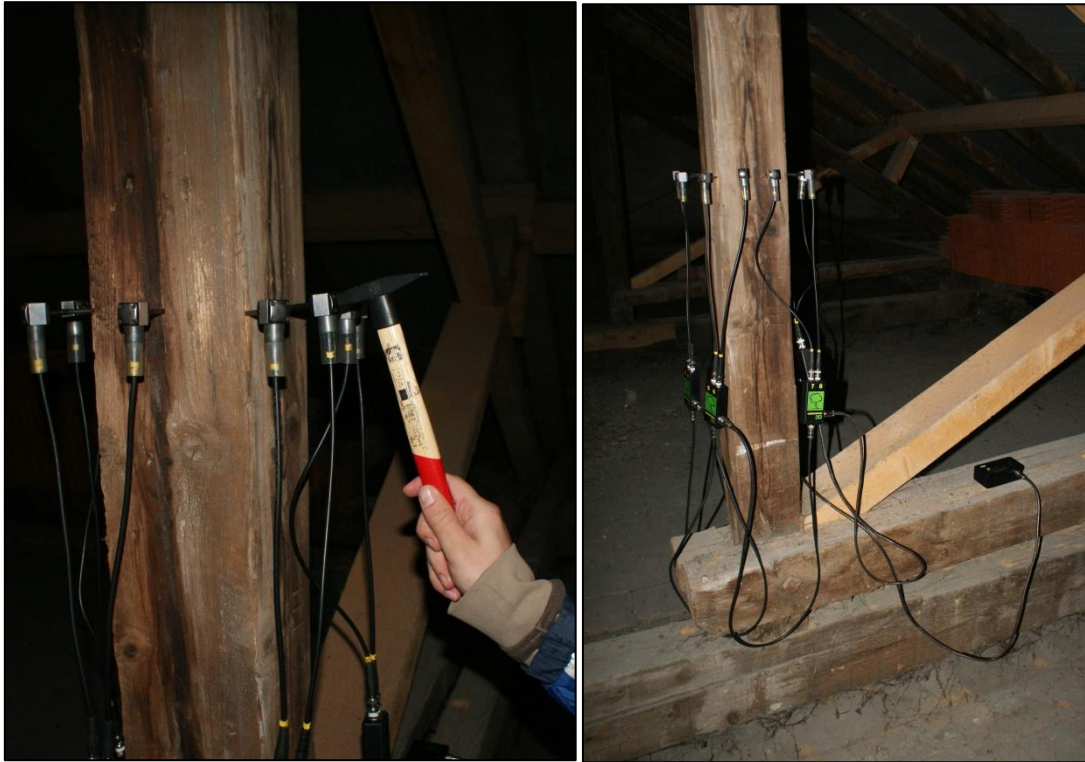
4. ábra: A 12 szondás FAKOPP koppintása (bal oldal) és összeállítása (jobb oldal) (a szerző felvételei)
