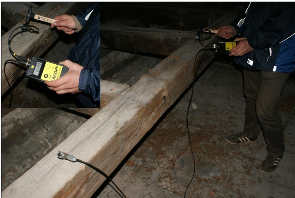
3. ábra: A két beütő tűskés FAKOPP használata az NYME „A” épület egyik tetőszerkezeti elemének vizsgálata közben (a szerző felvétele)
