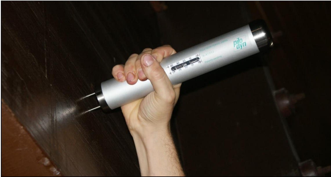
12. ábra: A Pilodyn használat közben, felhúzott állapotban (a szerző felvétele)
