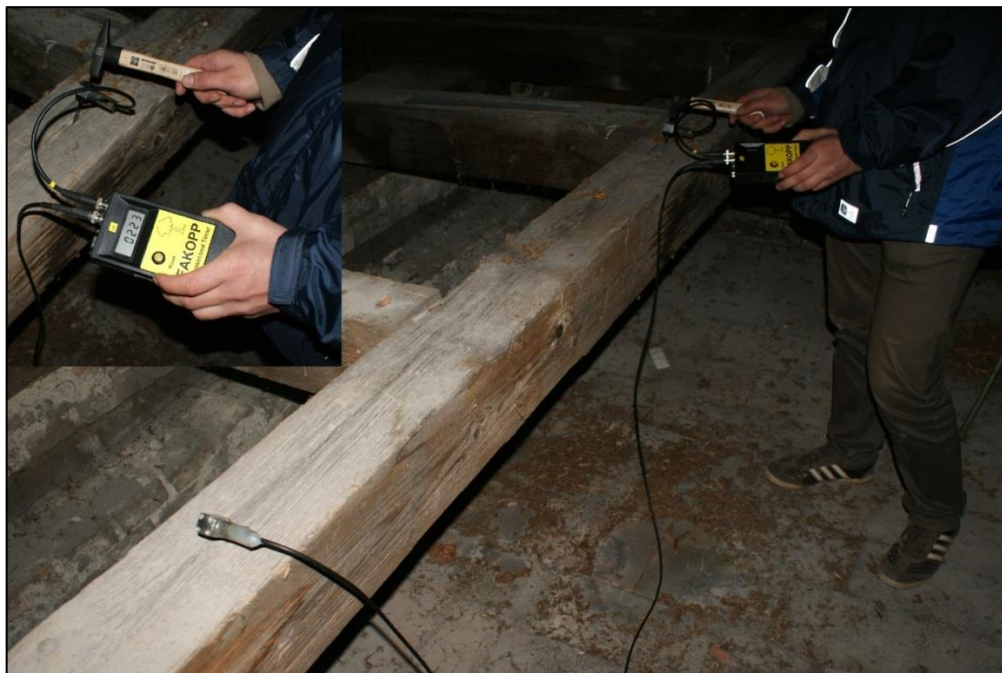
3. ábra: A két beütő tüskés FAKOPP használata az NYME „A” épület egyik tetőszerkezeti elemének vizsgálata közben (a szerző felvétele)
