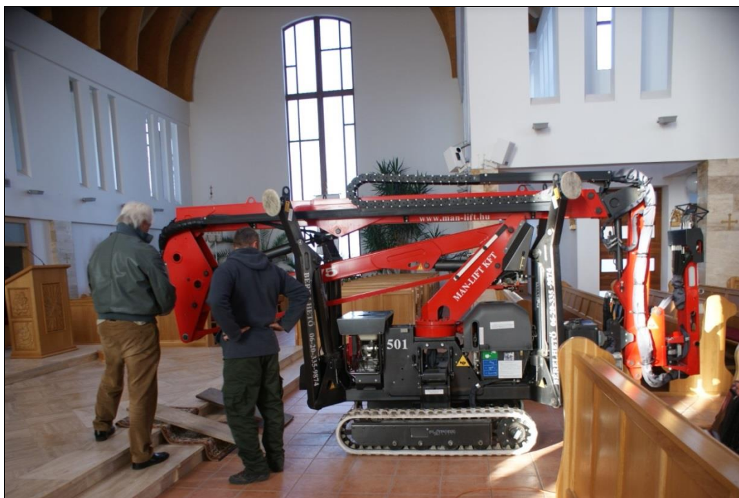
2. melléklet: Kosaras jármű használata a szigetszentmiklósi katolikus templom vizsgálatakor I. (a szerző felvétele)
