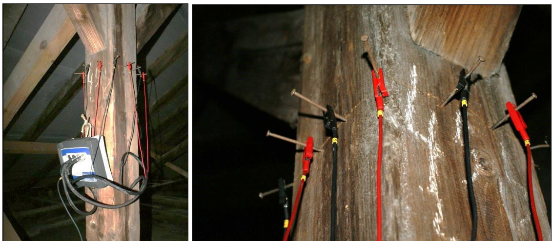
5. ábra: Az impedancia tomográf központi vevő egysége a rákötött elektródákkal (bal oldal), az egy síkban a gerendába beütött szegek és a rájuk csatlakoztatott elektródák (jobb oldal) (a szerző felvételei)
