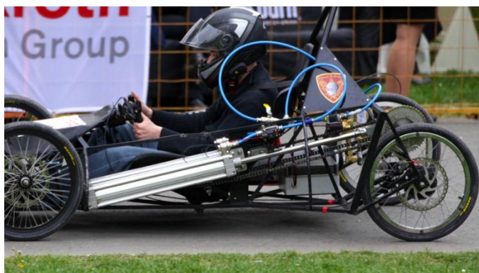
17. ábra: Láncos alternáló hajtás a Debreceni Széllovagok 2011-es járművén
