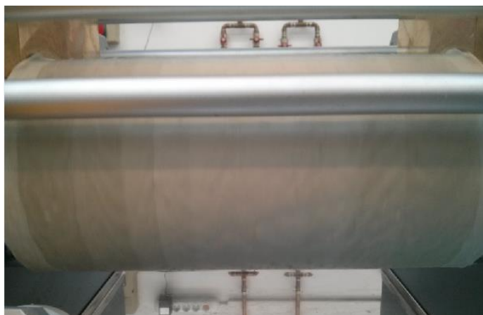
27. ábra: A hengershéken kialakult sávos szerkezet
