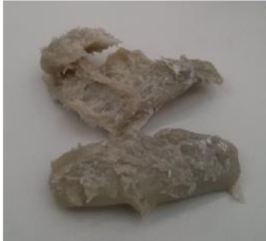
26. ábra: A belső keverőből kinyert, 4 m% bentonittal töltött anyag
