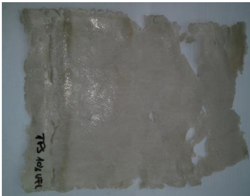
18. ábra: Az UFC-100 típusú cellulózzal erősített kompozit lap
