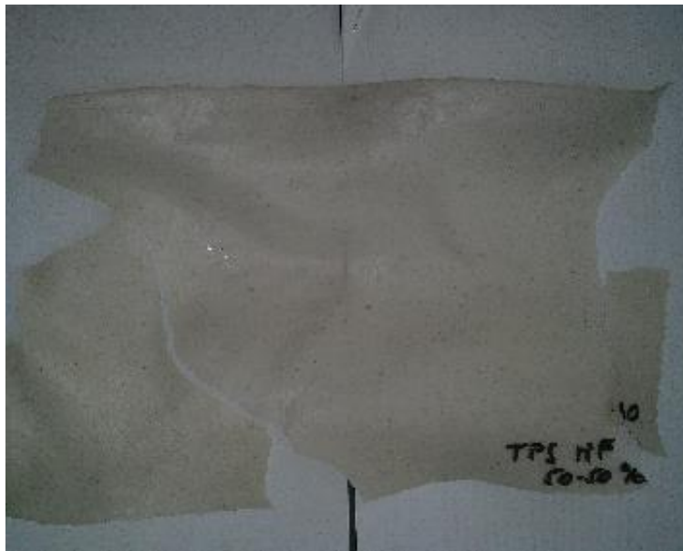
19. ábra: Az MF40-07 típusú cellulózzal erősített kompozit lap
