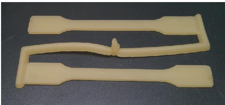
42. ábra: Fröccsöntött próbatestek
