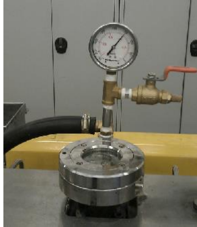
16. ábra: Az extruderre szerelt gáztalanító egység
