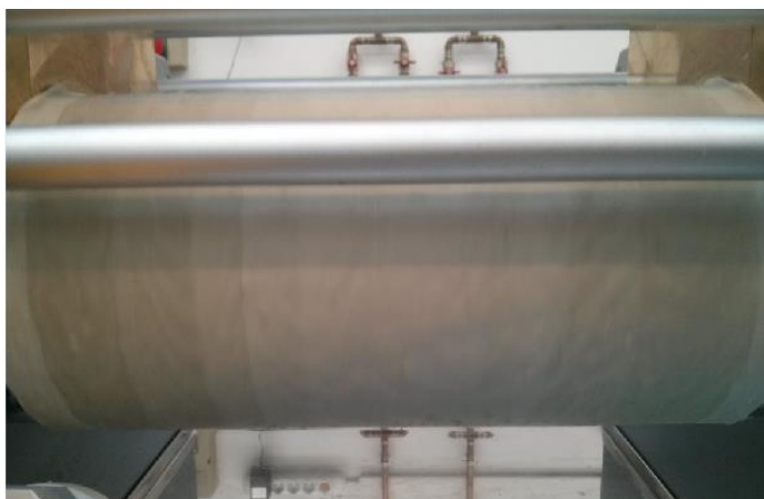
29. ábra: A hengerszéken kialakult sávos szerkezet
