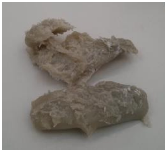
28. ábra: A belső keverőből kinyert, 4 m% bentonittal töltött anyag
