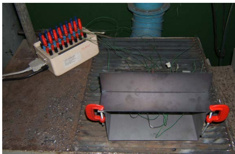
9.ábra: Az adatgyűjtő-munkadarab összeköttetés termoelemekkel
