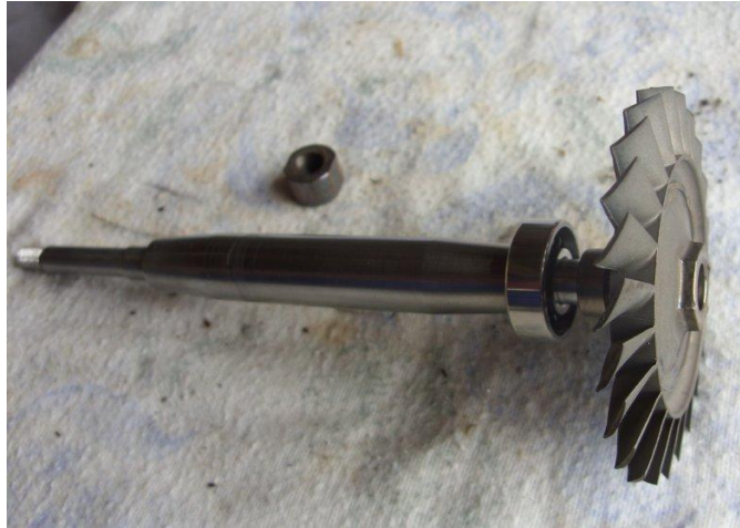
4.8.ÁBRA AXIÁLIS TURBINA KISMÉRETŰ SUGÁRHAJTÓMŰ RÉSZÉRE (ÖNTVÉNY) [10]
