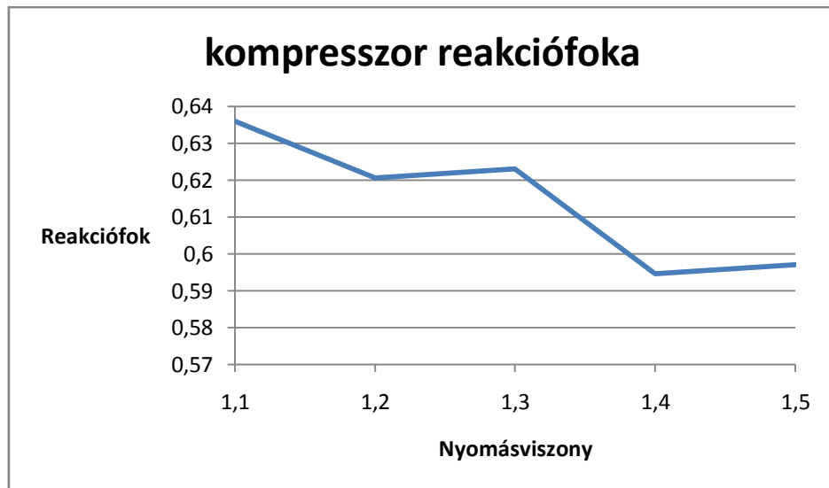
6.4.ÁBRA A REAKCIÓFOKOK A NYOMÁSVISZONY FÜGGVÉNYÉBEN
