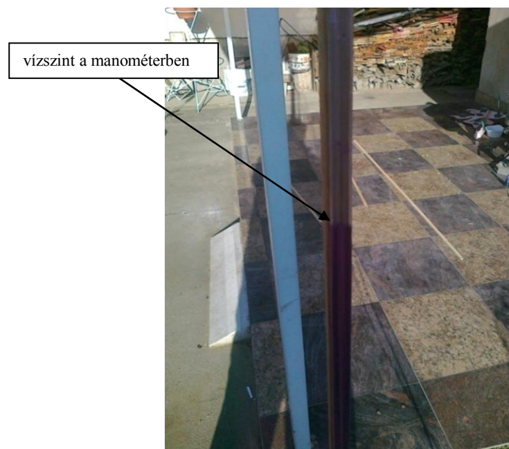
6.1. ÁBRA MANOMÉTER VÍZZEL TÖLTVE
