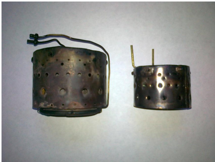
5.6. ÁBRA JOBB OLDALON A 3. GÉPEM ÉGŐTERE
