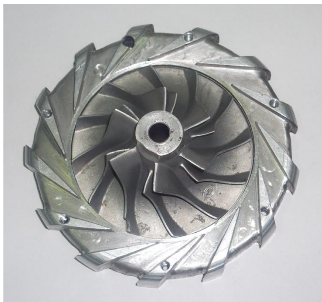
5.3. ÁBRA KÉZZEL ÉS EGY DARABBÓL KÉSZÜLT DIFFÚZOR
