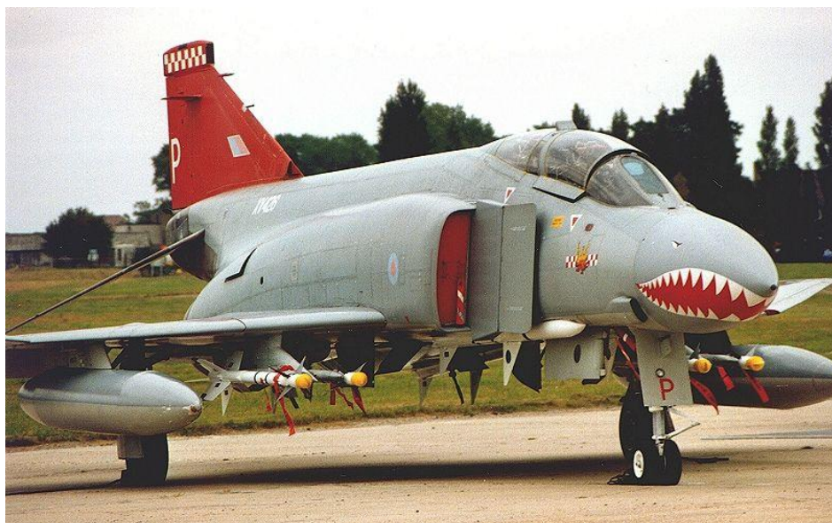
11. ábra: Phantom FGR.Mk.2, látható a módosított függőleges vezérsík 11
