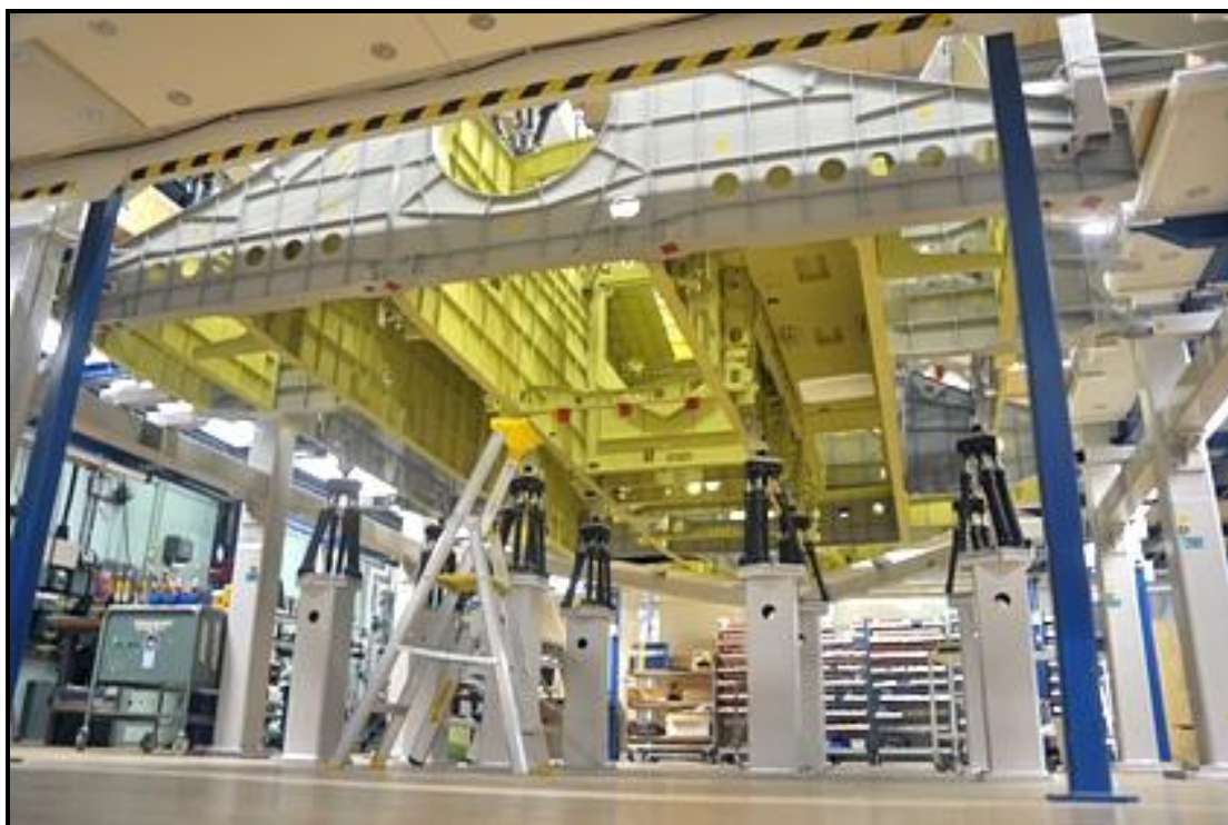
XII. ábra: A Dassault nEUROn sárkányszerkezetének építése a Saab linköpingi gyárában
