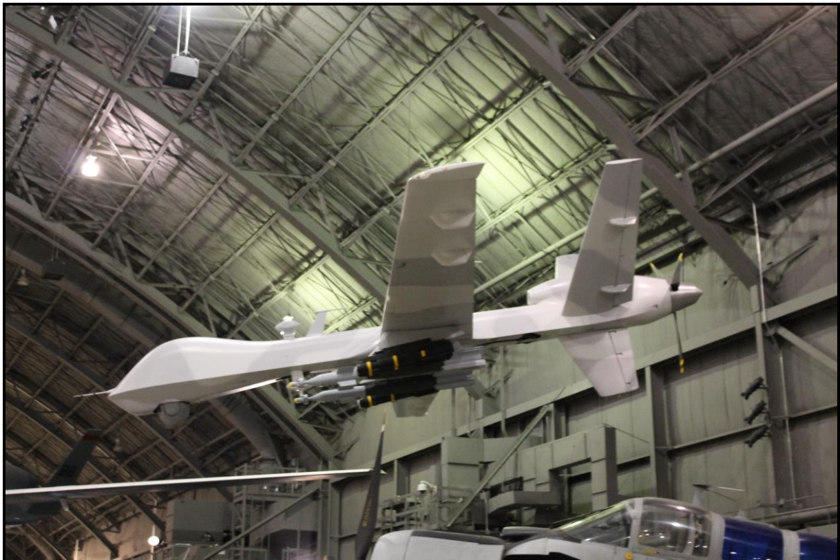
VII. ábra: Az MQ-9 Reaper (Predator-B) prototípusa, az YMQ-9. Jól látszanak a szárnyak és a törzs alatt a felfüggesztési pontok, melyekre AGM-114 Hellfire rakéták és GBU-12 Paveway II lézerbombák makettjeit függesztették
