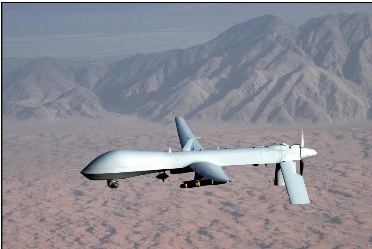
V. ábra: General Atomics MQ-1 Predator-A, napjaink egyik legelterjedtebb, legtöbbet alkalmazott UAV-je
