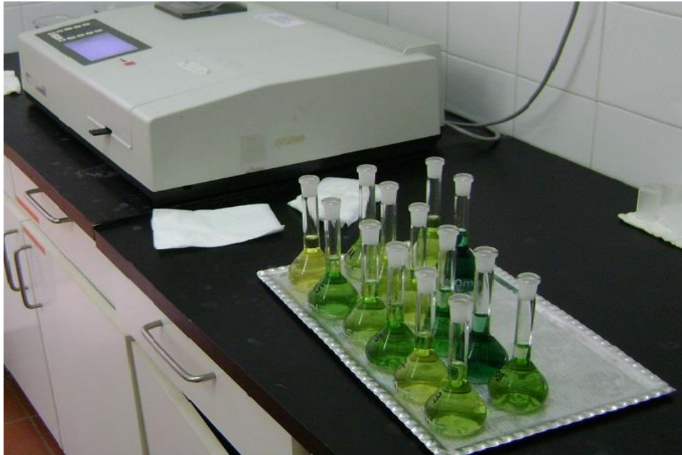
14. ábra Ammónium-tartalom meghatározása spektrofotométerrel (saját fotó)
