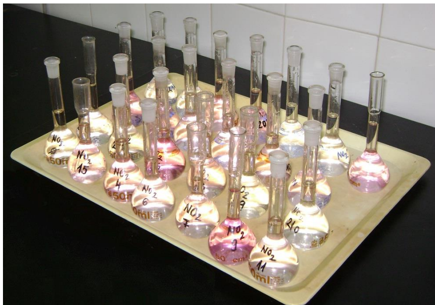
13. ábra \text{NO}_2^- mérésre előkészített vízminták (saját fotó)
