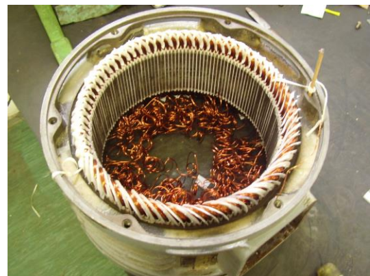
4.5. ábra. Kétpólusú tekercsfej készítés közben, 24 pólusú tekercsfej.
