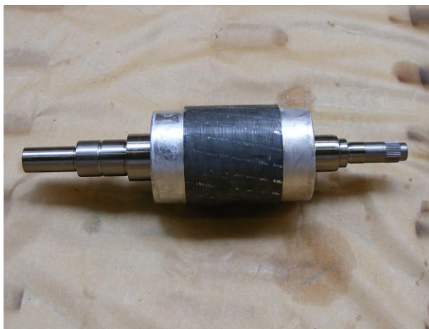
5.2. ábra. Kalickás forgórész, magas rövidrezáró gyűrűkkel.
