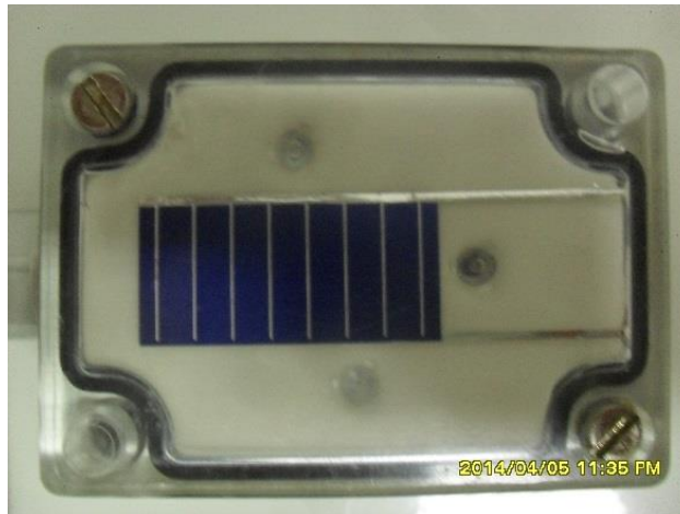
21. ábra: Mért napelem cella (Steca TA-SE1)
