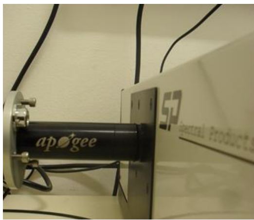
19. ábra: Monokromátor kimenetére rögzített spektrométer mérőfej
