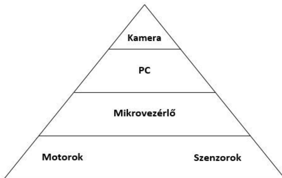
13. ábra: Az automata irányítás hierarchiája
