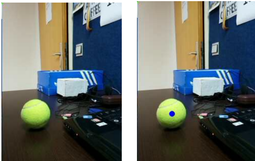
34. ábra: az eredeti kép (bal oldalt), a hisztogramokkal meghatározott pont (jobb oldalt)
