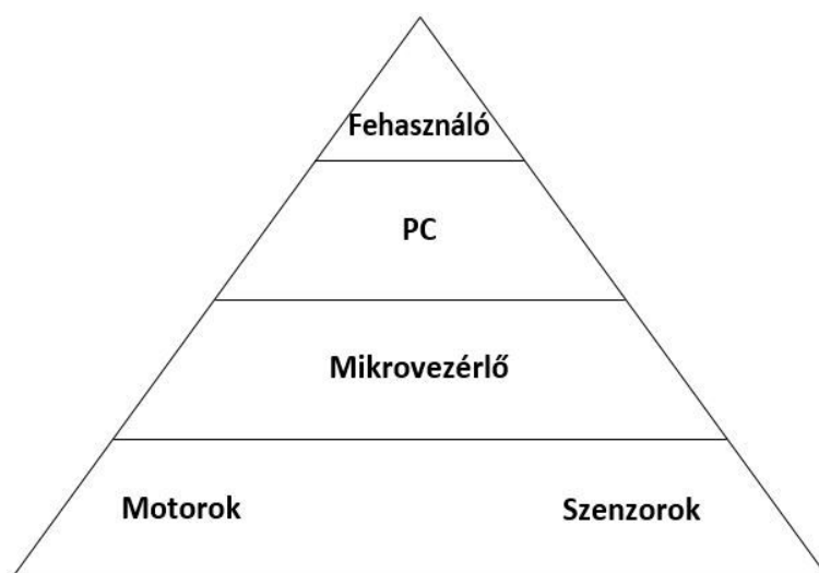
8. ábra: A kézi vezérlésű rendszer irányítási hierarchiája
