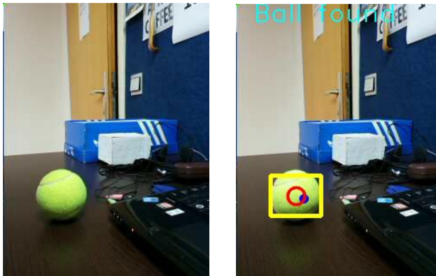
36. ábra: Az eredeti kép (bal oldalt), a megtalált eszköz (jobb oldalt)
