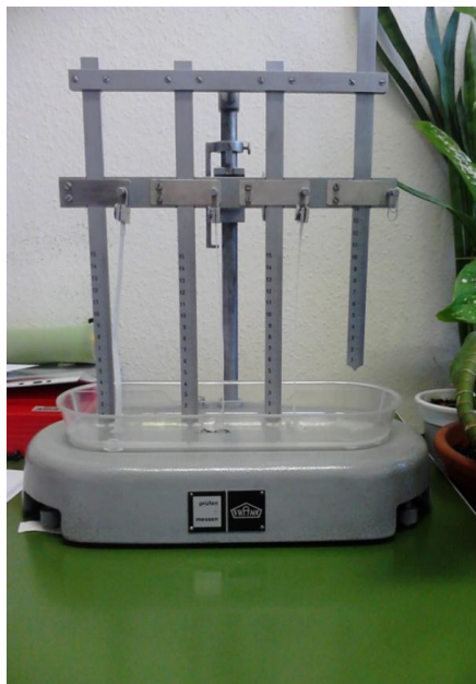
3.20 ábra Klemm-féle szívómagasság mérő
