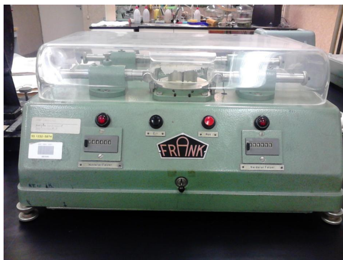
3.17 ábra Frank-típusú kettős hajtogató
