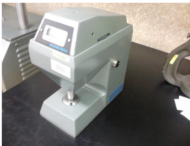
3.9 ábra Lorentzen-Wettre típusú vastagságmérő
