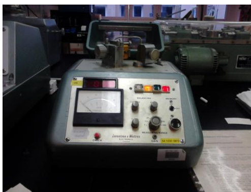
3.18 ábra Lorentzen-féle hajlítási merevség mérő
