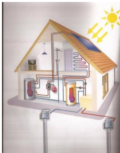
2. ábra Talajvíz hőszivattyú [4.] (20 o.)
