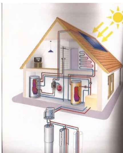
4. ábra Geotermikus mélyszonda [4.] (18.o)
