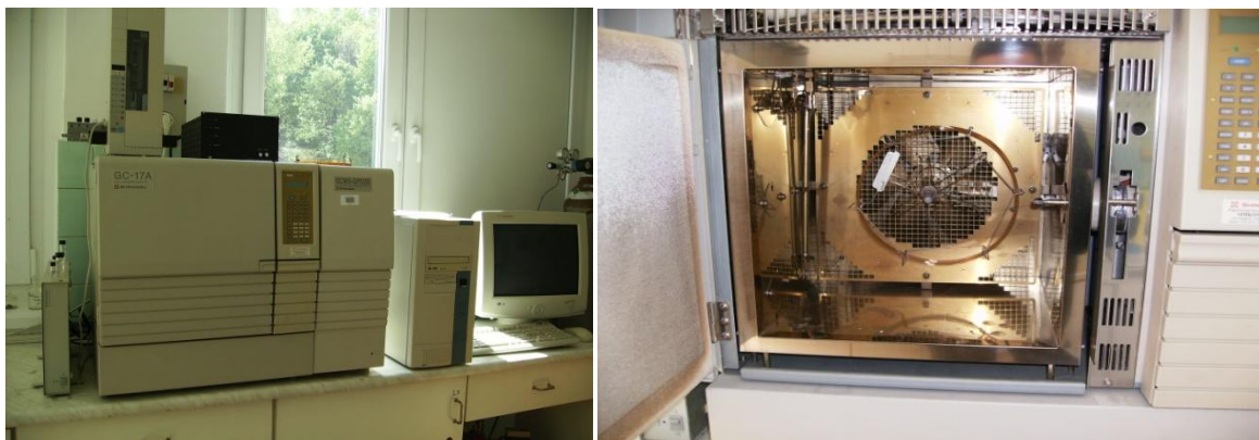
3-4.ábra : GC-MS kívülről (balra) és belülről (jobbra)
