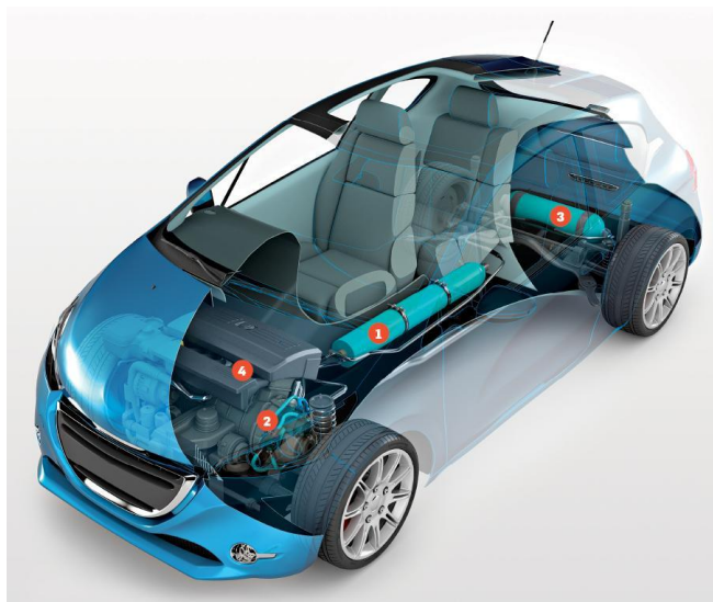
2. kép – A PSA levegős hybridje – ( www.popsi.com , 2014)
