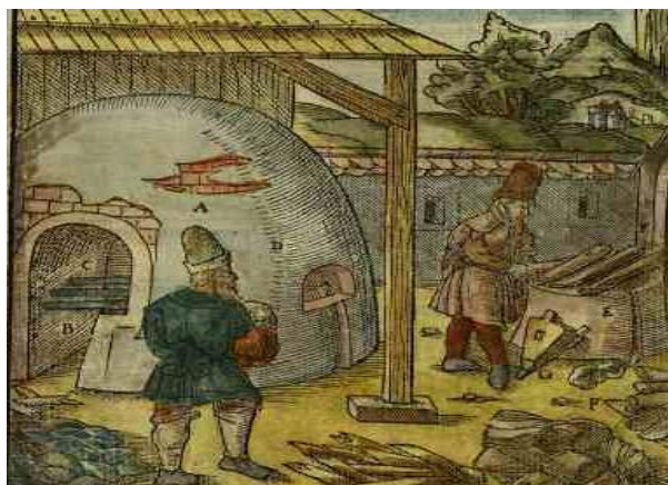
A lengyel és magyar leűzőkemence ábrázolása a De re metallica-ban (10. könyv. 243. ábra)
