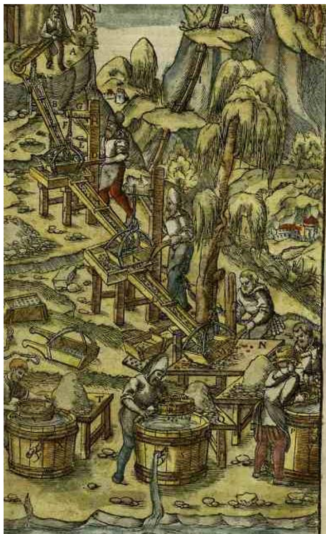
A besztercebányai rostasor (a rézérc előkészítési folyamata) a De re metallica-ban, 8. könyv, 149. ábra
