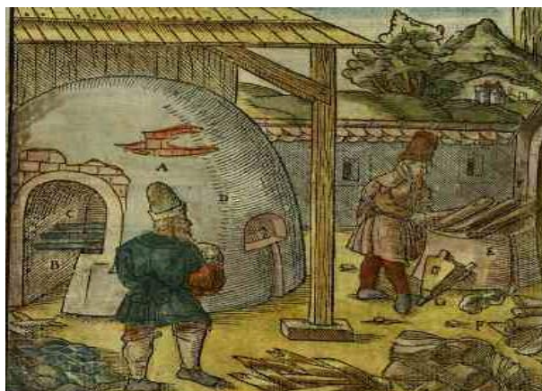
A lengyel és magyar leűzőkemence ábrázolása a De re metallica-ban (10. könyv. 243. ábra)
