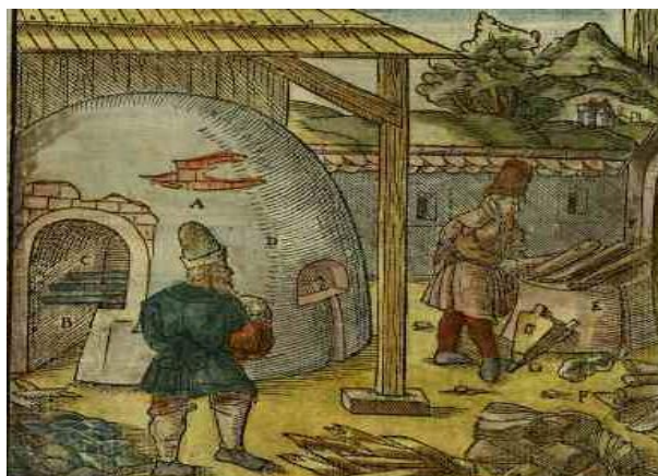
A lengyel és magyar leűzőkemenca ábrázolása a De re metallica-ban (10. könyv. 243. ábra)
