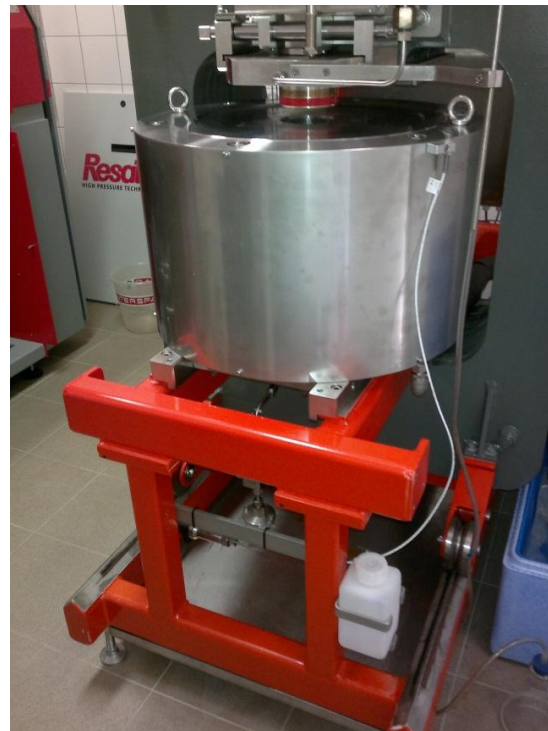
3. ábra FPU-100-2000 nagynyomású berendezés (Resato International B.V., Hollandia)
