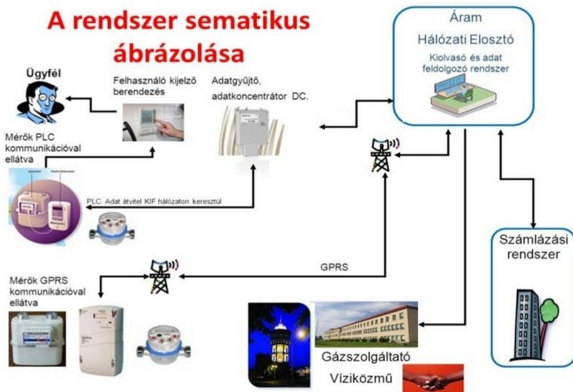
12. ábra A Smart Grid rendszer integrálása egyéb vállalati folyamatokkal (számlázás, beszerzés)
