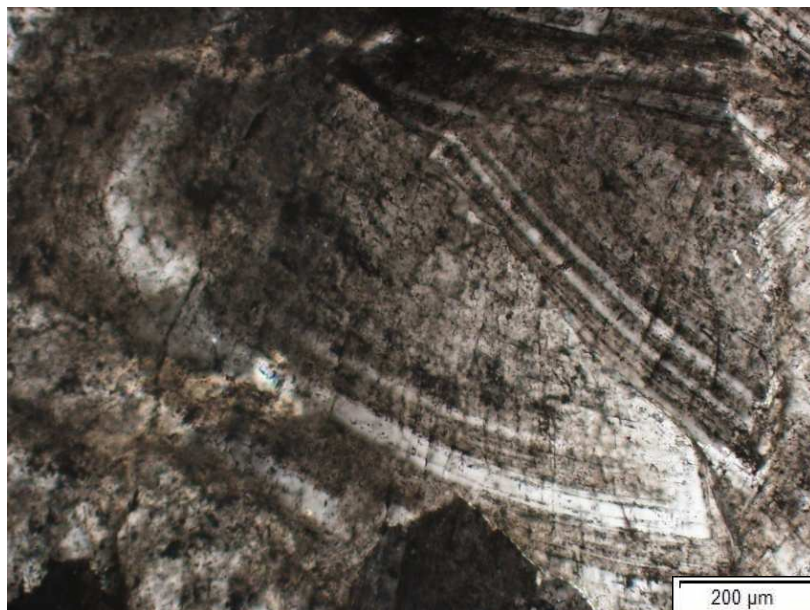
10. ábra Nyereg dolomit típus mikroszkópos képe, melyen jól látható a zárványdús mag, és a tiszta szegély (keresztezett nikol állás 20X nagyítás)
