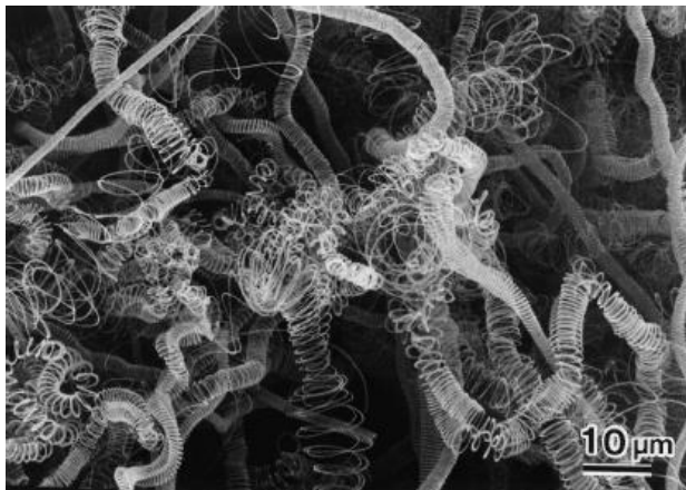
6. ábra: Felére csökkentett acetilén-hidrogén aránnyal szintetizált minta [16]
