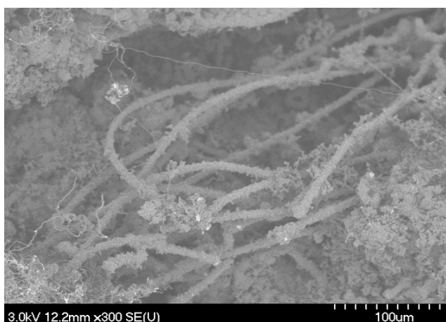
21 a. ábra: 20 mL/perces tiofén áramlási sebesség mellett szintetizált minta SEM képe
