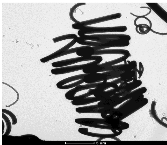
16 b. ábra: 780\text{ }^{\circ}\text{C} -on hidrogénnel szintetizált minta TEM képe
