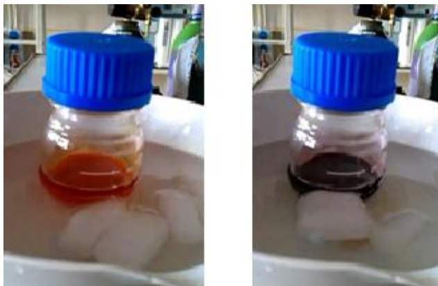
15. ábra Polimer oldat nanoszálás struktúra kialakulása előtt (balról) és után (jobbról).
