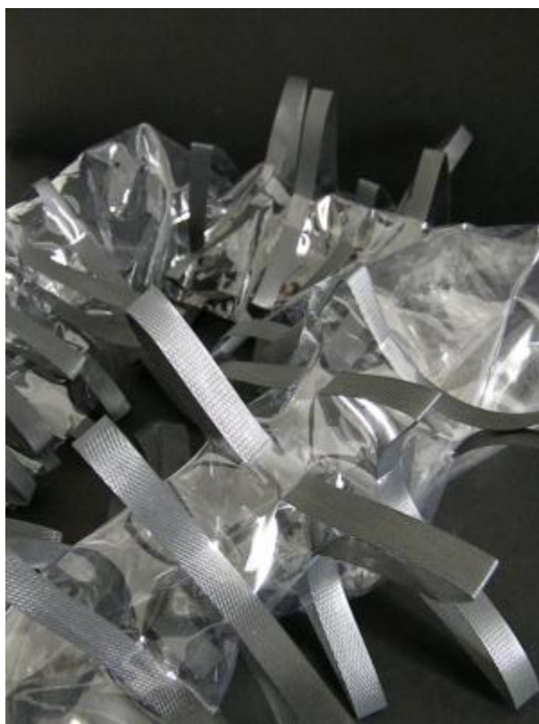
XXV. Kísérlet lágy műanyag fóliával (szádnyíláson belüli vetülékfémzéshez hasonló megoldás)
