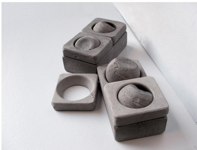
4. ábra Gömbcsuklós szerkezetre kísérlet
