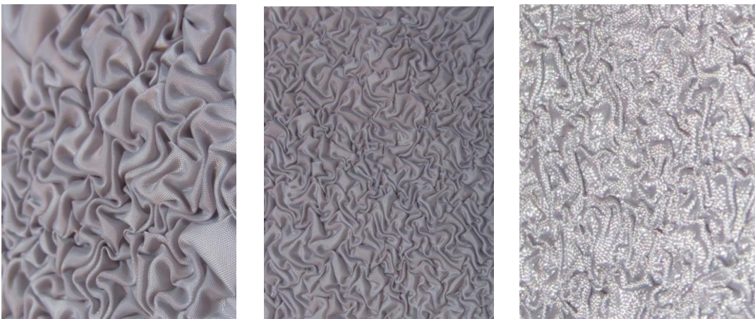
3. kép: Az idő elteltével nő a zsugorodás mértéke (balról jobbra): 30 sec, 40sec, 60 sec
