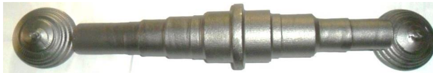
43. ábra. Hengerelt tengely a véghulladékokkal
