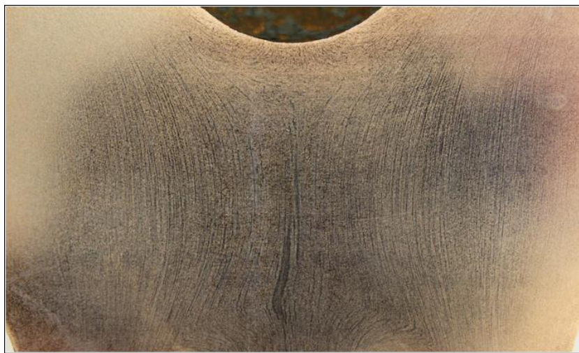
9. ábra: A mintadarab felülete mélymaratás után
