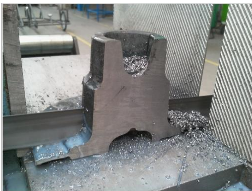
7. ábra: A kovácsdarab darabolása egy keretes fűrészgépen
