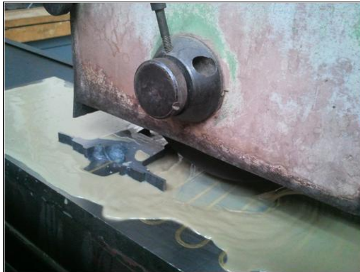
8. ábra: A mintadarab előkészítése síkköszörűgépen
